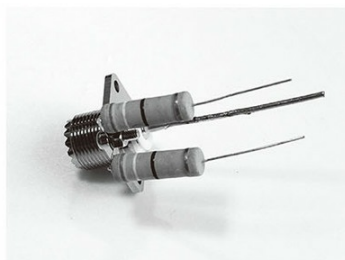
↑写真8／M型レセプタクルの角穴にM3ネジで抵抗2本を固定する。
