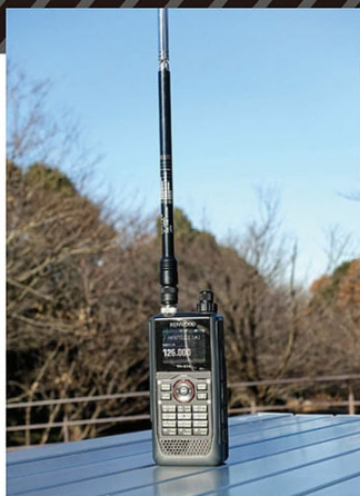
↑写真4／ワイドバンドハンディロッドアンテナとTH-D74の組み合わせでエアバンドが良く聴こえた。
