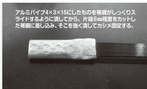
↑写真13／帯鋼素子の連結ループの作り方
