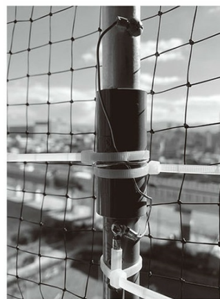
↑写真4/結束バンドで固定したコイル。
