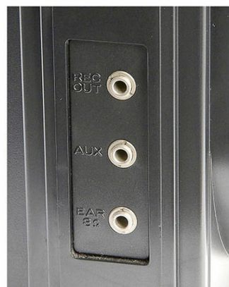
↑左側面には録音端子、外部入力端子、イヤホン端子と並ぶ。当時はラジカセやテープレコーダーをつなぎ録音していた。
