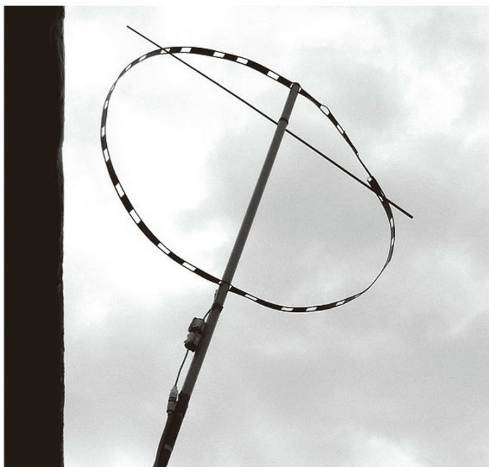
↑写真4/長いガラスファイバー・ボールでベランダに設置した例。
