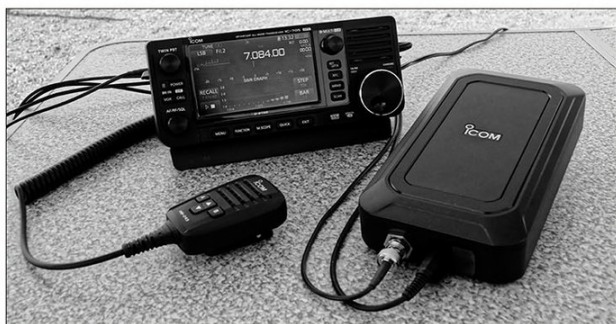
↑アイコムIC-705とオートアンテナチューナーAH-705。AH-705は190×105×40mmと移動運用の際、邪魔にならないコンパクトサイズのアンテナチューナーだ。
