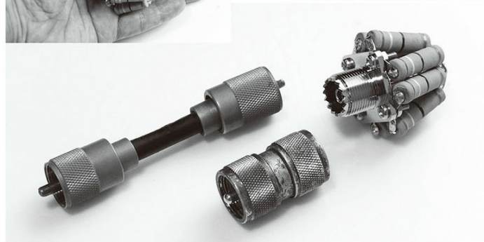
↓写真5／M型両端プラグ（オス）MA-PPか、両端M型プラグの短いケーブルを用意しておく、いろいろな場面で使うことができる。
