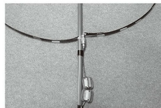
↑写真3/M形コネクター(メス)にハンダ付け。その先にフロートバランを挿入。
