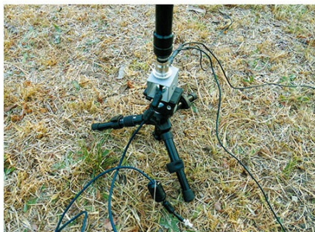
↑写真8/アンテナはローカルのOMが自作した治具を挟み三脚に取り付ける。接続部から同軸ケーブルとアースが伸びている。
