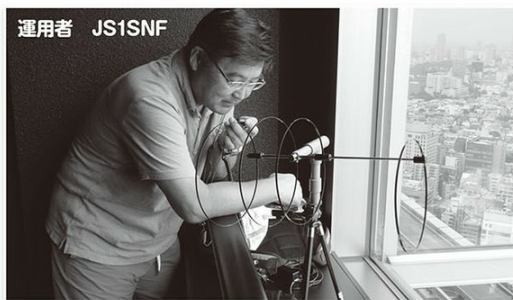
↑写真4/小型三脚と塩ビパイプでアンテナを取付けた。
