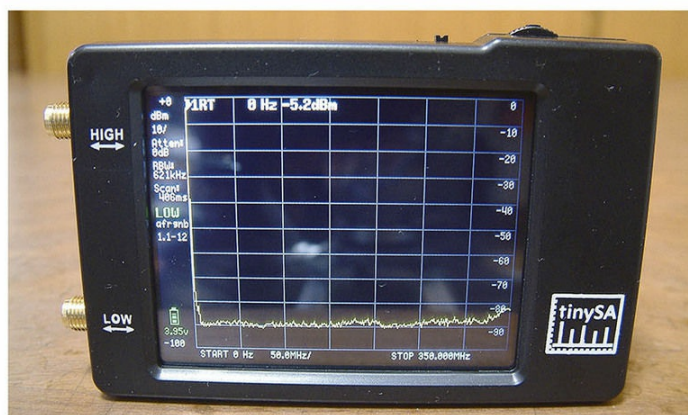
↑写真1 / 中国製格安スペアナ tinySA。
