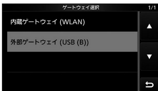
↑写真8/IC-705:「ゲートウェイ選択」画面で「外部ゲートウェイ(USB(B))」を選択する。
