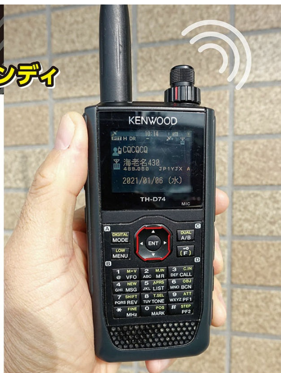
↑写真1/半透過型液晶ディスプレイと十字キーが特徴。
