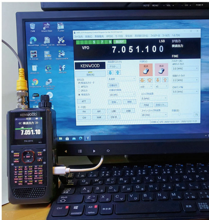
↓写真10／TH-D74はPCと接続してPCからコントロールすることもできる。
