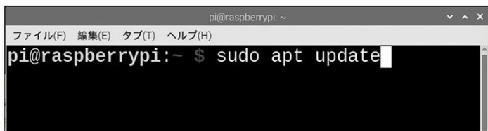
↑写真3/メニューバーの「LXTerminal」を立ち上げてコマンドでアップデートする。
