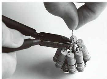
↑写真10／軟銅線の余分な長さ部分をニッパーで切断する。
