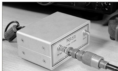
↑写真3/シャック内でVNWA3を使いチューニング結果を測定。
