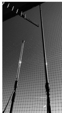
↑写真2 / 左は430MHz用J型アンテナ、右は28MHz用マイクロバートアンテナ。
