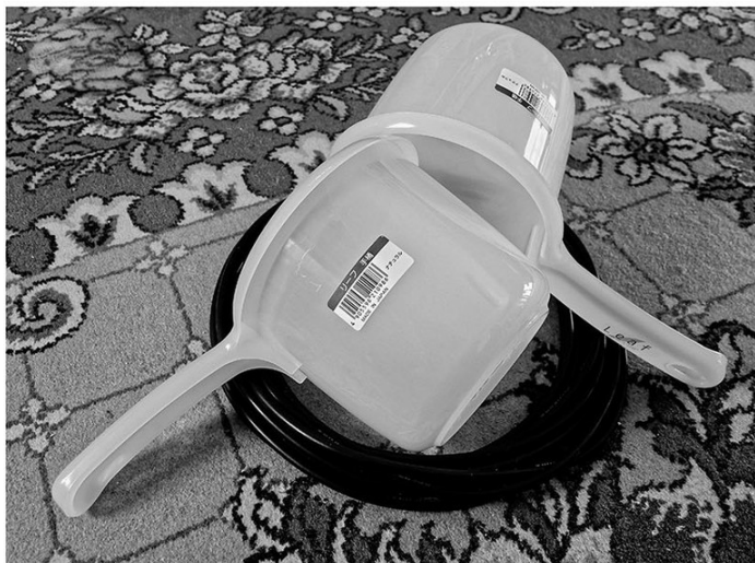
↑湯桶と同軸ケーブル。新たに購入した湯桶2個と同軸ケーブル。これでアースコイルを製作する。
