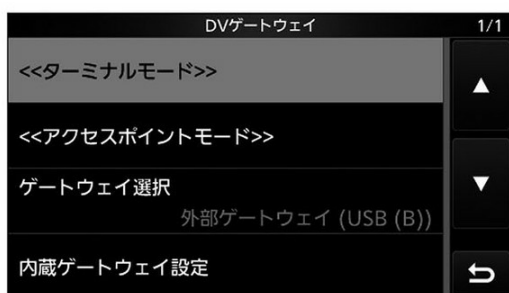
↑写真9/IC-705:「DVゲートウェイ」画面で「ターミナルモード」を選択する。
