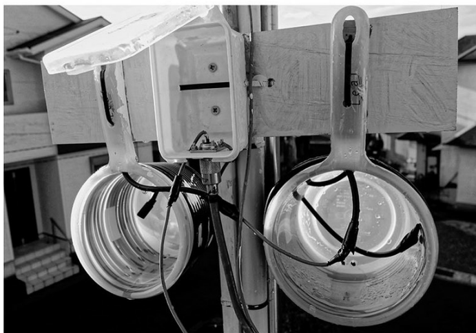
↑アースコイルAとB。このアンテナの重要箇所であるアースコイルAとBの取り付け状態。最初に湯桶に同軸を巻き、それを絶縁テープで仮止めてから同軸を通す穴を開け、そのあと水抜き用の穴を各2個開口した。この開口部はかなり有効で、雨が溜まらないようになっている。このアースコイルはかなりの重さになるので取り付けには工夫が必要。
