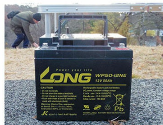
↑写真5/鉛シールドバッテリー。取っ手がついた大型のもので無線機への給電に使う。
