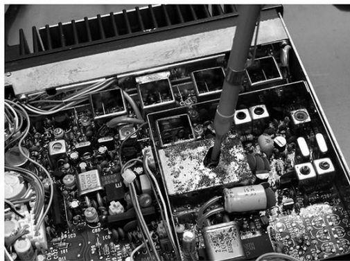
↑赤色のトリマコンデンサーを回してみると特定位置で「ガー」音が聴こえてきた。やはりこのパーツが不良だ。
