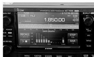
↑AH-705を動作させるとSWR値が1.850MHzで1.5以下になった。ワイヤーを張るスペースがあれば、憧れの1.9MHz帯でのQSOも可能だ。
