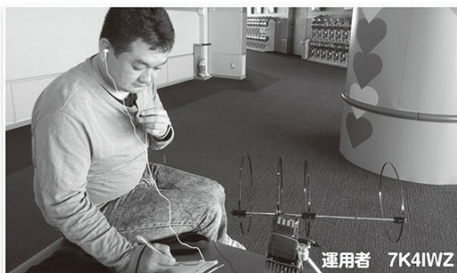
↑写真3/玩具の三脚に放熱器を付け、ハンディ機を載せピンマイク、イヤホン、外付けバッテリー等で高層ビル(都会の岩山)で、お手軽運用。
