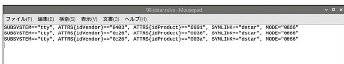
↑写真4/ファイル「99-dstar.rules」を表示した画面。2行目と3行目が追記した記述。
