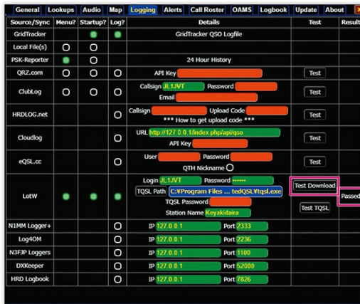
↑写真31/ResultにPassedと表示されるのを確認する。
