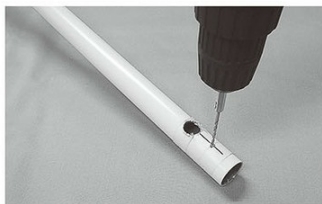
↑下側の穴は、(穴の下端が)床から2cmくらいの位置がよさそう。下穴を3mmくらいのドリルであける。
