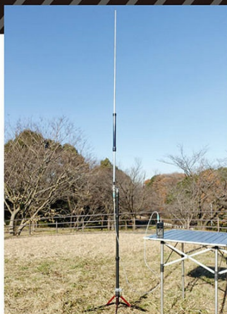
↑写真5a／7～50MHz広帯域アンテナとTH-D74の組み合わせでハムバンドを聴いてみた。
