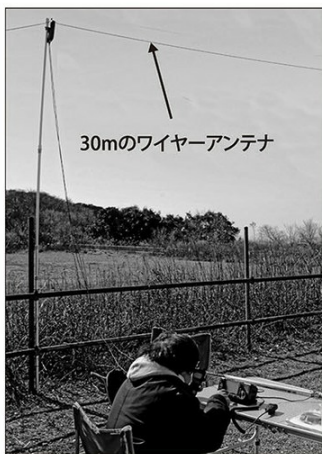
↑1.9MHz帯運用するためには30m以上のワイヤー長を推奨している。そこで30mのワイヤーを張ってみた。
