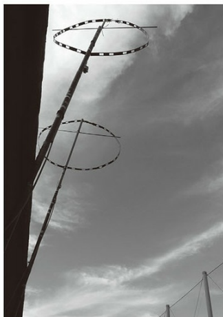
↑写真8/位相差給電の実験。
