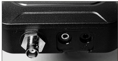
↑無線機接続側(入力側)には、BNCコネクタとコントロール端子、DC電源端子がある。コントロールケーブルは抜けやすいので、引っ張る力を加えないよう注意する。
