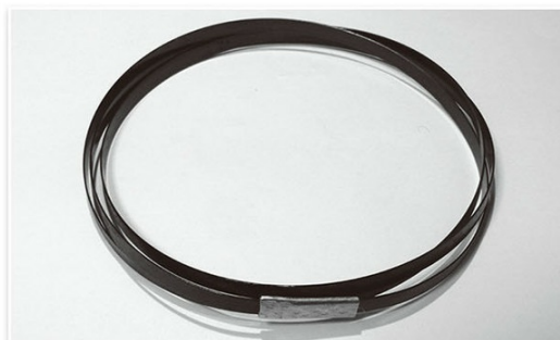
↑写真19／素子の小型収納方法は、素子を3巻にする。
