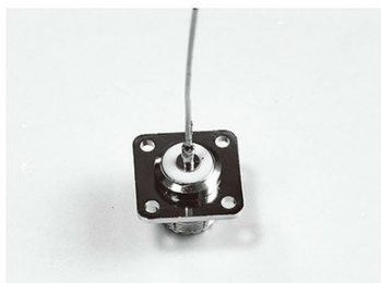
↑写真7／M型レセプタクルの芯線端子に1.6mmφ軟銅線をハンダ付けする。
