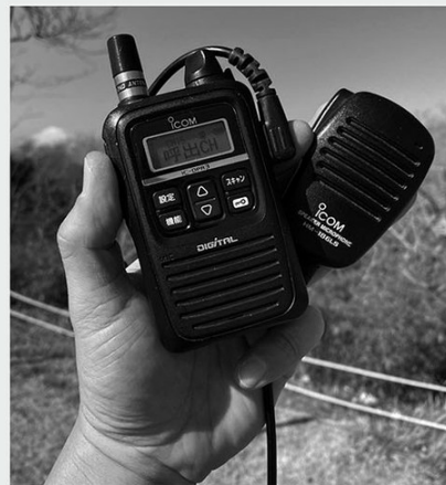
↑山岳移動では、ショートアンテナで混信対策（DM向けな方法）。
