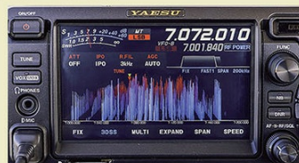
↑ヤエスのHF/50MHz機、FTDX10の3次元スコープを見ながら、運用すれば、コンディションの良し悪しも視覚的にわかるので重宝する。
