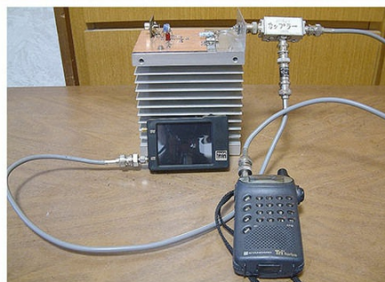
→写真2 / 無線機とスペアナの測定接続。
