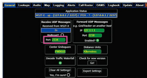
↑写真29/Received UDP Messages 枠の「Port」番号を設定。
