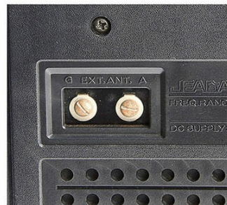
↑背面に外部アンテナ端子を装備。Gはアース側、Aはアンテナ線を意味している。短波重装備の本機なら、ぜひ活用したい。
