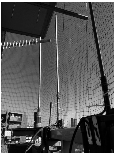
↑写真2 / 左は430MHz用J型アンテナ、右は28MHz用マイクロバートアンテナ。
