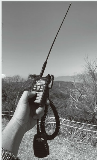
↑少し利得の高いアンテナを装着すれば、1W機でも充分遊べるデジタル簡易無線。
