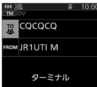
↑写真5/接続するとディスプレイの左上に「USB COM」が表示される(ID-52の画面例)。
