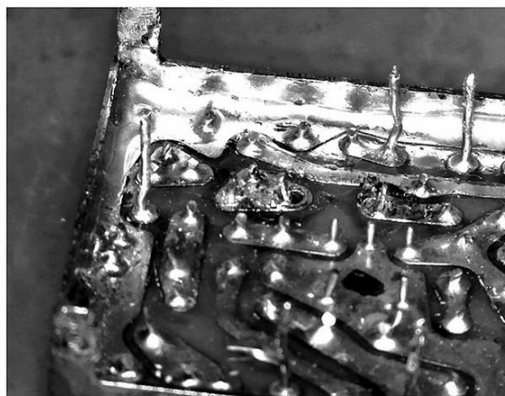
↑トリマコンデンサーの足部分のハンダ除去後の様子。
