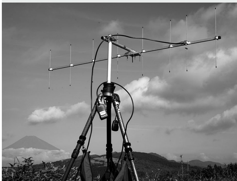
↑八木アンテナで、目的の信号だけを拾う方法（真っ当な方法）。
