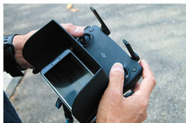
↑ドローンのコントローラー。スマホのアプリと連動させないと操作ができない安全設計。2.4GHz帯で動かしているので技適マークがあります。
