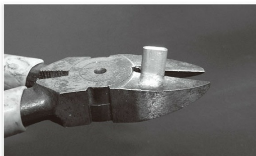
↑写真15／ハンダの流入を防ぐために、写真14のP-5.5を袋とじにする。
