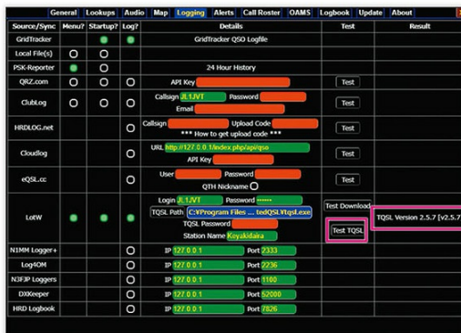
←写真32/「Test TQSL」ボタンをクリックし、TQSLのバージョンが出るのを確認。
