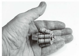
←写真3／M型レセプタクル（メス）を使った、掌におさまる小型のダミー・ロード。
