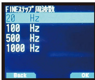
↑写真8／周波数のステップは[STEP] ボタンにより設定できる。
